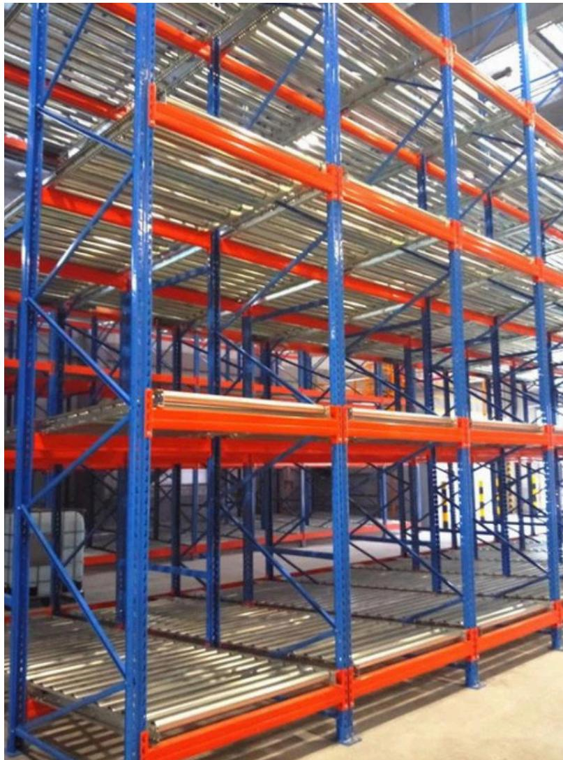
El sistema carton Flow está compuesto por módulos provistos de rieles, estos módulos son los encargados de trasladar la mercancía surtida por la parte trasera y retirada por la parte delantera Primeras Entradas, Primeras Salidas (PEPS). Maximiza la consolidación de diferentes órdenes a surtir con varios tipos de productos o piezas.
