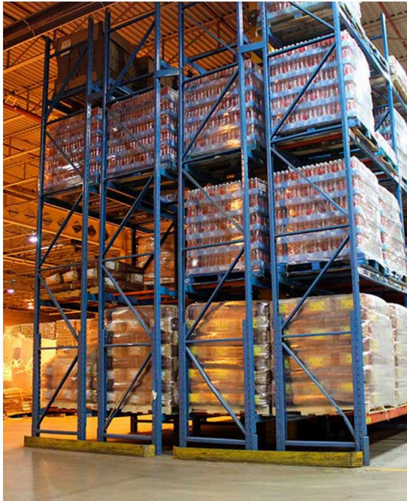
El sistema de racks double deep es un sistema de almacenamiento que permite almacenar dos paletas en profundidad en el mismo nivel de un rack, lo que aumenta la capacidad de almacenamiento sin necesidad de ampliar el espacio físico.
